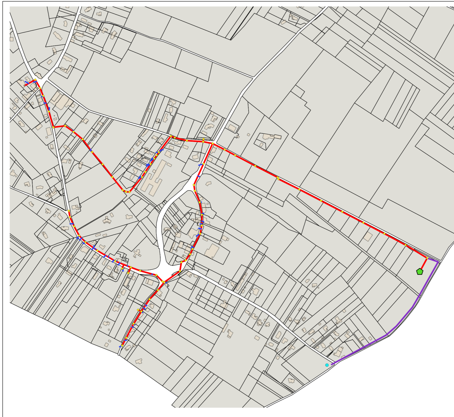
Figure 43: Carte du réseau d'assainissement des eaux usées
